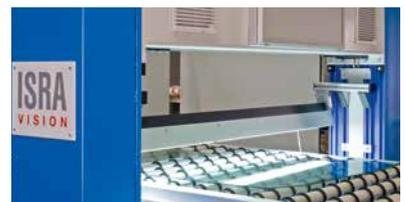
**P<sup>2</sup>-颜色** 能够可靠地监控镀膜颜色，并且有助于确保玻璃板得到一致的标准化影像，同时节约了资源。
